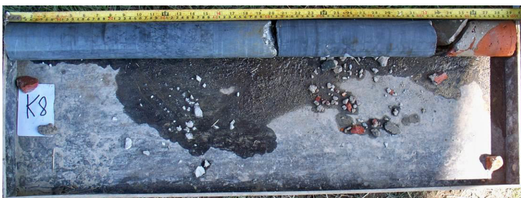
Obr. č. 8 – diagnostický vrt K8
